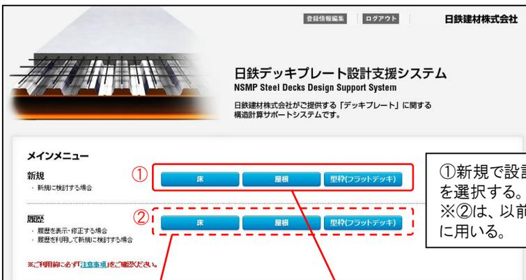
①新規で設計する部位「床」、「屋根」、「型枠(フラットデッキ)」を選択する。
