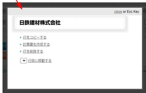
④行(列)をコピー，または削除する場合，行(列)番号をクリックすると左図のようにポップアップが表示されます。『行(列)をコピーする』をクリックすると，選択した次の行(列)に同じ設計条件が複製されます。
